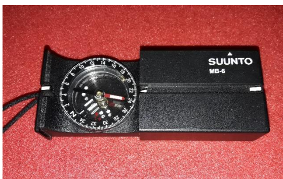
Brújula de precisión con mira y espejo, marca Suunto® (foto del autor).
