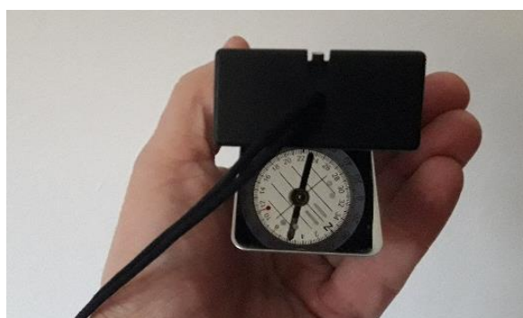
Espejo de la brújula de precisión con mira, para poder leer el rumbo indicado (foto del autor).
